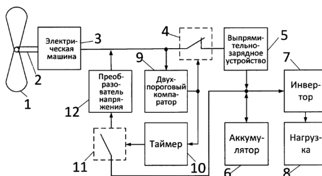
Рисунок 1.4 – Структурная схема ветроэнергетической установки
