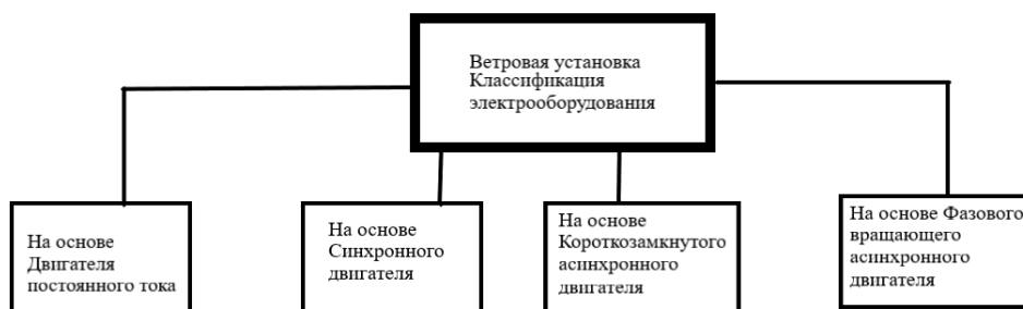
Рисунок 1.5 – Классификация электрооборудования ветровых установок
